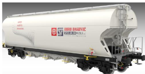
ĐĐ Specijalna vozila su u 2024. razvili i kraću varijantu Tagnpps 96 m<sup>3</sup> – vagon koji je kraći za 500mm, a ima veću zapreminu za 1 m<sup>3</sup> od Tagnpps 95 m<sup>3</sup> - uz istu maksimalno moguću težinu vagona i tereta od 90 t, kraći vagon omogućuje formiranje kompozicije od više vagona nego prije → ista količina tereta može se prevesti u manje kompozicije/vlakova → potrebno manje lokomotiva → potrošit će se manje goriva. Ovaj tip vagona će biti
