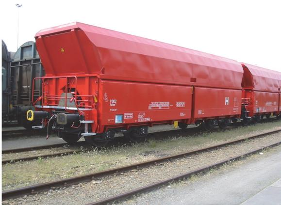
Vagon je namijenjen za prijevoz različitih tipova rastresitih roba otpornih na atmosferske utjecaje (ugljen). Istovar vagona je vrši principom prirodne gravitacije na mjestima za istovar (donji spremnici), za vrijeme toga mora biti osiguran neometan istovar tereta ispod razine tračnica. Utovar vagona se vrši kroz gornje spremnike ili utovarivačima koji osiguravaju ravnomjerno raspoređivanje tereta.
