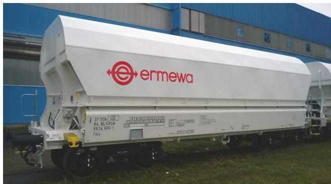
Vagon je namijenjen za transport vapnenca i različitih tipova rasutog tereta otpornog na atmosferske utjecaje. Istovar tereta vagona se izvodi prirodnom gravitacijom kroz istovarne otvore (podzemni spremnici), s tim da mora biti osigurano nesmetano ispuštanje tereta ispod najviše razine kolosijeka. Utovar vagona obavlja se preko gornjih silosa ili trakastih utovarivača kako bi se osigurao ravnomjeran raspored tereta.
