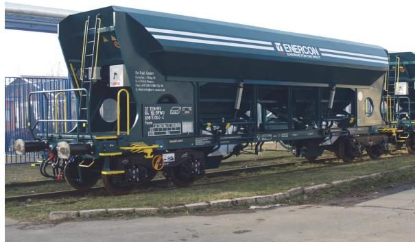
Vagon je namijenjen za prijevoz pjeska granulacije 0-2,0 mm, šljunka granulacije 8-20 mm te šljunka granulacije 18-32 mm, u rinfuzi, otpornih na atmosferske utjecaje.
